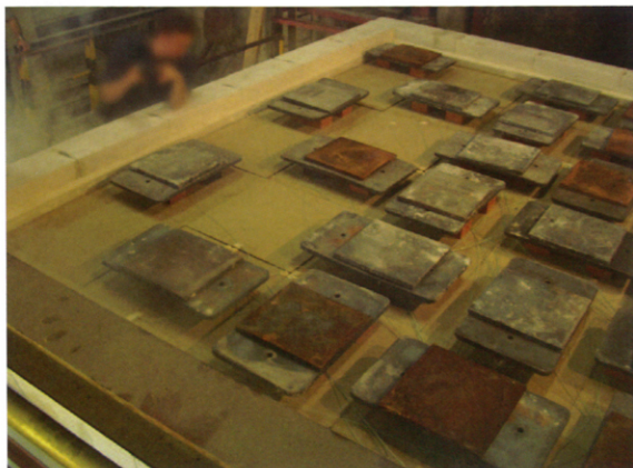
系统防火性测试按照DIN 4102/2.
